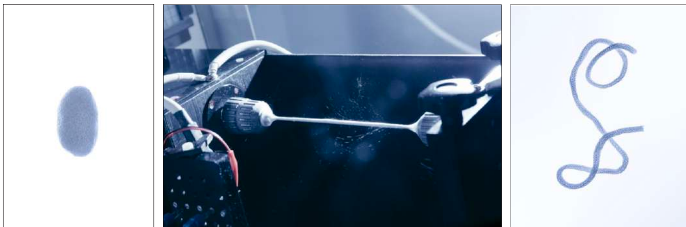
Da un bozzolo, attraverso l'elettrofilatura, fino all'ottenimento di un tubo cavo di SILKBridge®
