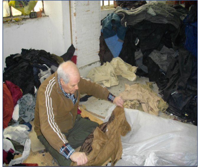
2 - Apertura degli stracci da stoffe tessute per il ciclo a umido
