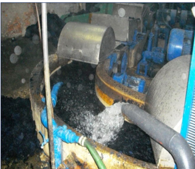
11 - Lavaggio e stracciatura ad umido degli stracci
